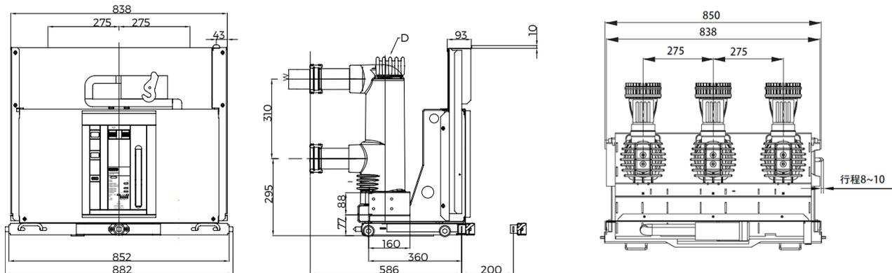
当额定电流 2500A 及以上时，断路器须带冷却罩 D
